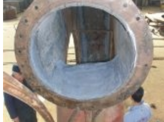
Покрытие корпусов насосов.
