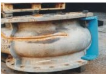
Холодная сварка корпуса насоса.
