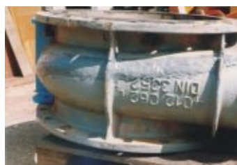
Холодная сварка корпуса насоса.
